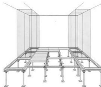
Verzinkter C-Profil-Rahmen mit Hammerkopfschrauben und Zahnscheiben auf den höhenverstellbaren Stützen verschraubt
